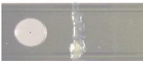
Выступившая смазка из подшипника
